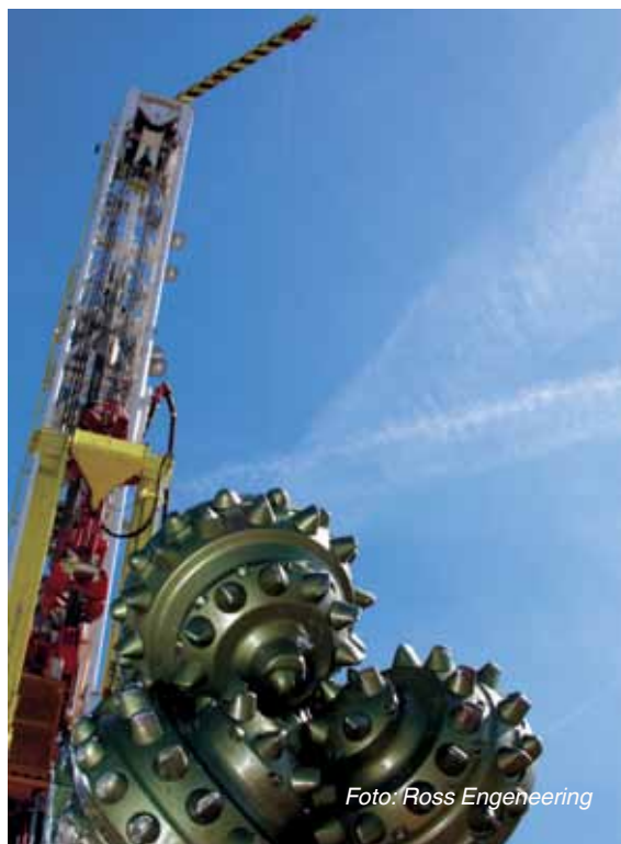
Borekrone til termisk vandboring.
